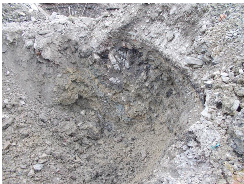
Abbildung 2 Schadhaltige Auffüllung im Umfeld des geborgenen Erdtanks, Bereich Wandprobe P 3
